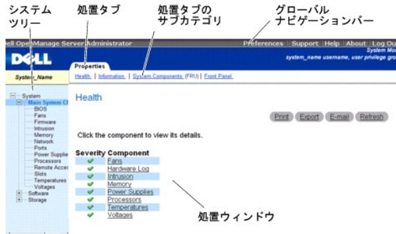
図 3-2 は、モジュラシステムにシステム管理者特権でログインしたユーザー用のサンプル Server Administrator ホームページのレイアウトを示します。
